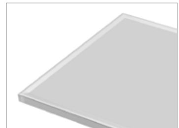
Die umlaufende Tropfkante verhindert das Herunterlaufen von Wasser.
