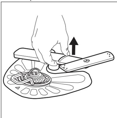
2. Reinigen Sie den Sprüharm unter fließendem Wasser. Entfernen Sie Verunreinigungen aus den Öffnungen des Sprüharms mit einem spitzen Gegenstand, z. B. einem Zahnstocher.
