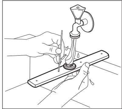
4. Setzen Sie zum Einsetzen des Sprüharms das Montageelement in den Sprüharm und drehen Sie ihn gegen den Uhrzeigersinn, um ihn am Kanal zu befestigen. Achten Sie darauf, dass das Montageelement einrastet.
