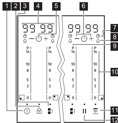
Управление прибором осуществляется с помощью сенсорных полей. Работа функций подтверждается выводом информации на дисплей, а также визуальной и звуковой индикацией.
