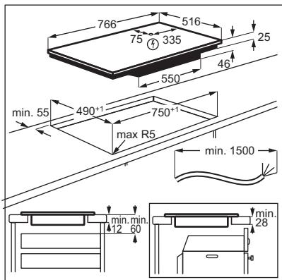
Zoek de videotutorial "Hoe installeert u uw AEG inductiekookplaat - installatie op het aanrecht" door de volledige naam die in de onderstaande afbeelding staat in te typen.
