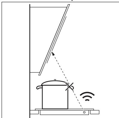
D'autres appareils contrôlés à distance peuvent bloquer le signal. N'utilisez pas ce type d'appareil à proximité de la table de cuisson lorsque la fonction Hob²Hood est activée.
