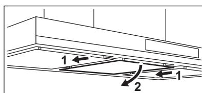
2. Kallista suodattimen etuosaa hiukan alaspin ja vedä sen jälkeen.
