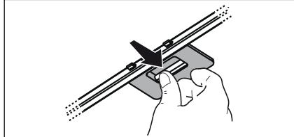
**4.2 - Aktivni karbonski filter koji se može oprati** - Zasićenje karbonskog filtra se pojavljuje poslije manje-više produljene uporabe s obzirom na tip kuhinje i na urednost u čišćenju filtera za uklanjanje masnoće. U svakom slučaju je potrebno zamjeniti kartuš barem svaka četiri mjeseca.
