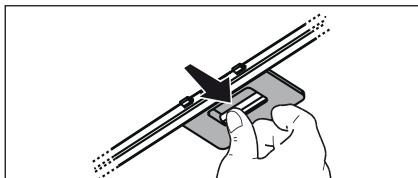
**4.2 Filtre à charbon actif - Filtre à charbon actif lavable** - La saturation du charbon actif se constate après un emploi plus ou moins long, selon la fréquence d'utilisation et la régularité du nettoyage du filtre à graisses. En tout cas, il est nécessaire de changer le filtre après, au maximum, quatre mois.
