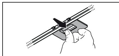
إن إهمال قواعد تنظيف الجهاز وعدم تعويض وتنظيف المصافي يؤدي إلى خطر الحرائق.
