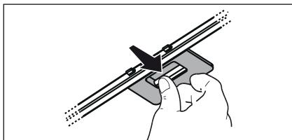
**4.2 Hiilisuodatin - Pestävä aktiivihiilihiilisuodatin - Hiilisuodattimen kyllästys** tapahtuu pidemmän käytön jälkeen riippuen keittiötypistä ja rasvasuodattimen puhdistustiheydestä. Joka tapauksessa suodatin on vaihdettava vähintään neljän kuukauden välein.
