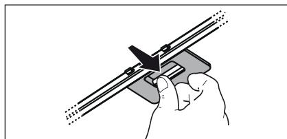
**4.2 Aktivkohlefilter - Der waschbare Aktivkohlefilter - Je nach der Benutzungsdauer des Herdes und der Häufigkeit der Reinigung des Fettfilters tritt nach einer mehr oder weniger langen Benutzungsdauer die Sättigung des Aktivkohlefilters auf. Auf jeden Fall muß der Filtereinsatz mindestens alle 4 Monate ausgewechselt werden. Er kann NICHT gereinigt oder erneut aktiviert werden.**
