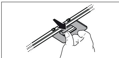
**4.2 Kolfilter - Aktivt kolfilter som kan rengöras** - Kolfiltret mättas efter en mer eller mindre lång tidsperiod beroende på i vilken utsträckning fläkten används, på typen av matlagning och hur regelbundet fettfiltren rengörs. Det är under alla händelser nödvändigt att ersätta kolfilterpatronen minst var 4 månad. Filtret kan INTE rengöras eller återanvändas.
