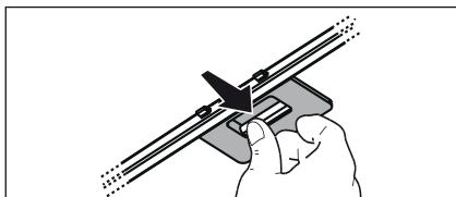
**4.2 Filtro al carbón activo - Filtro al carbón activo lavable** - La saturación del carbón activado ocurre después de mas o menos tiempo de uso prolongado, dependiendo del tipo de cocina y de la regularidad de limpieza del filtro de grasa. En cualquier caso es necesario sustituir el cartucho al menos cada 4 meses. NO puede lavarse o reciclarse.
