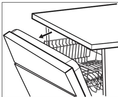
AirDry wird automatisch bei allen Programmen eingeschaltet.
