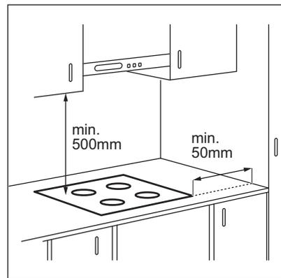
Si el aparato se instala sobre un cajón, la ventilación de la placa puede calentar el contenido del cajón durante el proceso de cocción.
