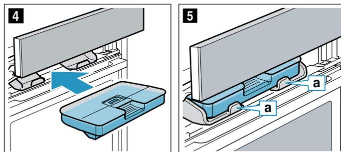
7. Blende langsam nach unten schieben, dann nach hinten drücken, bis sie vollständig geschlossen ist. Der Wassertank ist gefüllt. Sie können Betriebe mit Dampf starten.
