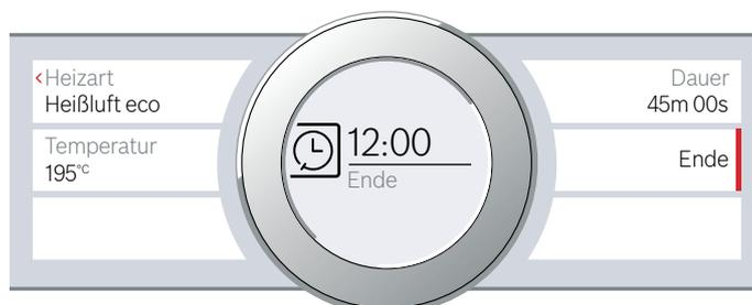
5. Mit Taste start/stop  $\triangleright$  starten. Im Display steht die Uhrzeit, zu der das Gerät startet.
