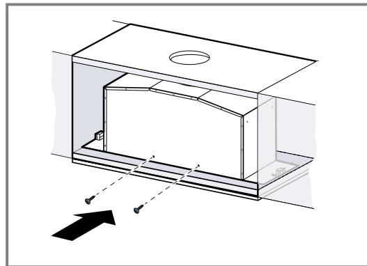
Si les vis ne sont pas accessibles de l'extérieur, elles peuvent également être montées de l'intérieur.
