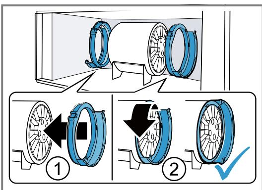
2. Insérer le filtre anti-odeurs dans les supports de fixation du filtre.
