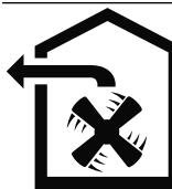
L'air ne doit pas être acheminé dans une cheminée servant à l'évacuation des gaz d'appareils qui sont utilisés pour la combustion de gaz ou d'autres combustibles (cela ne s'applique pas aux appareils de recyclage).
