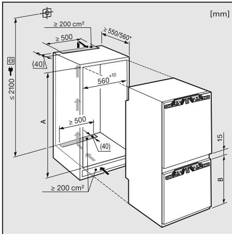
\* Der deklarierte Energieverbrauch wurde mit einer Nischentiefe von 560 mm ermittelt. Das Kältegerät ist bei einer Nischentiefe von 550 mm voll funktionsfähig, hat aber einen geringfügig höheren Energieverbrauch.
