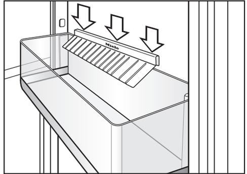
Die Lamellen des Flaschenhalters ragen in das Flaschenbord und geben den Flaschen beim Öffnen und Schließen der Gerätetür einen besseren Halt.
