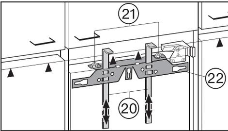
■ Schrauben Sie die Muttern (21) ab, und nehmen Sie die Befestigungstraverse (22) zusammen mit den Montagehilfen (20) ab.
