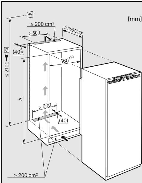
\* Der deklarierte Energieverbrauch wurde mit einer Nischentiefe von 560 mm ermittelt. Das Kältegerät ist bei einer Nischentiefe von 550 mm voll funktionsfähig, hat aber einen geringfügig höheren Energieverbrauch.
