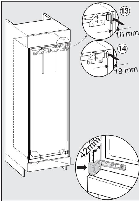
■ Schieben Sie das Kältegerät nun soweit in die Einbaunische, bis alle Befestigungswinkel oben und unten an der Vorderkante der Möbelseitenwand anschlagen.
