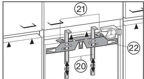
■ Schrauben Sie die Muttern (21) ab, und nehmen Sie die Befestigungstraverse (22) zusammen mit den Montagehilfen (20) ab.
