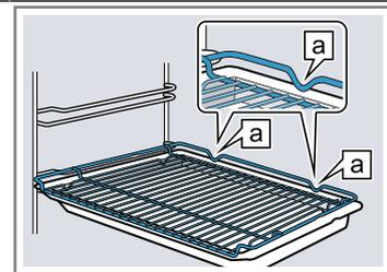
Rost Den Rost mit der offenen Seite zur Gerätetür und der Krümmung
