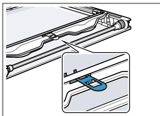
3. Die Innenscheibe an der Gerätetür mittig ausrichten.
