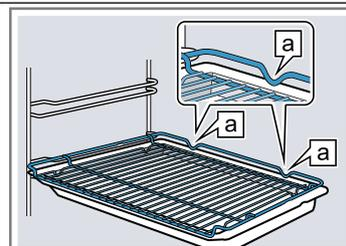
Rost Den Rost mit der offenen Seite zur Gerätetür und der Krümmung
