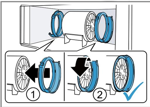
2. De geurfilters in de filterhouders schuiven.
