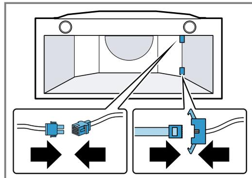
De stekker kan slechts in één positie wordt aangesloten.
