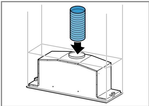
2. De verbinding met de afvoerluchtopening maken.
