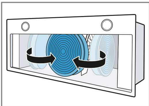
4. Het geurfilter verwijderen.
