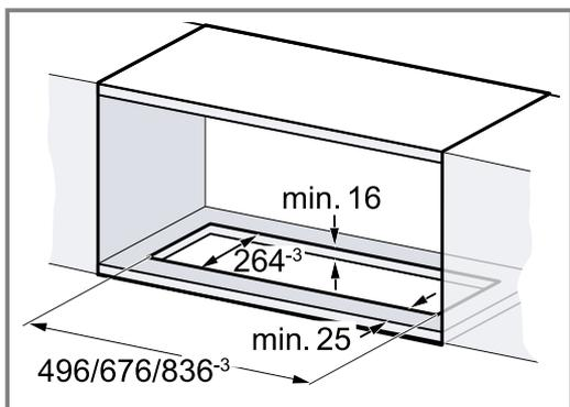
2. Realizzare un'apertura per il tubo di scarico o sopra oppure dietro il mobile da incasso.
