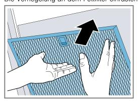
3. Falls der Fettfilter falsch eingesetzt wurde, die Verriegelung vorsichtig nach vorne drücken, den Fettfilter entnehmen und korrekt einsetzen.
