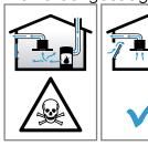
► Immer für ausreichend Zuluft sorgen, wenn das Gerät im Abluftbetrieb gleichzeitig mit
