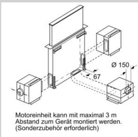
Motoreinheit kann mit maximal 3 m Abstand zum Gerät montiert werden. (Sonderzubehör erforderlich)
