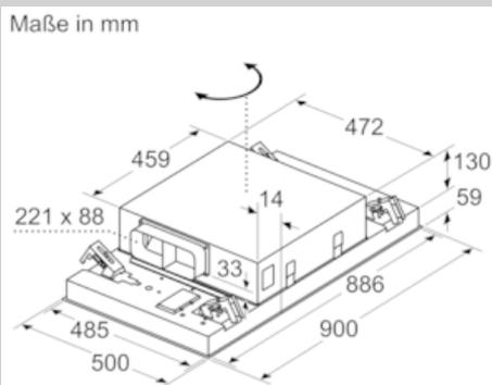
Lüfterauslass kann in alle vier Richtungen gedreht werden
