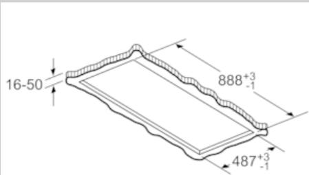
Nicht direkt in die Gipskartonplatte oder ähnliche Leichtbaustoffe der abgehängten Decke montieren. Geeignetes Untergerüst erforderlich, das fest in der Betondecke fixiert ist.
