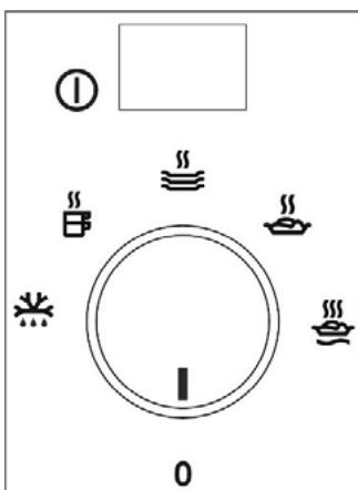
Het bedieningspaneel heeft een functieknop en een aan/uit-schakelaar. Het bedieningspaneel is alleen zichtbaar wanneer de lade open is.
