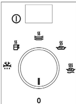
Il pannello comandi è dotato di un selettori e un interruttore di accensione On/Off. Il pannello comandi è visibile solamente se il cassetto è aperto.
