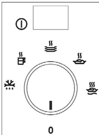
Die Bedienelemente bestehen aus dem Thermostat und dem Ein-/Aus-Schalter. Sie sind nur sichtbar, wenn die Geschirrschublade geöffnet ist.
