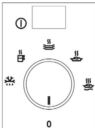
Le tableau de commandes comporte un thermostat et un bouton marche/arrêt. Le tableau de commandes n'est visible que lorsque le tiroir est ouvert.
