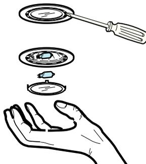
3. Byt ut lampan (använd endast halogenlampor max. 20 Watt - typ G4).
