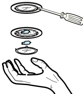
3. Udskift den beskadigede lyspære med en ny (der må kun anvendes halogenpærer på max. 20 Watt – type G4).
