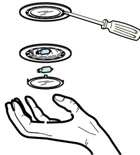
3. Cambiar la bombilla dañada (lámparas halógenas mas. 20 vatios, G4).
