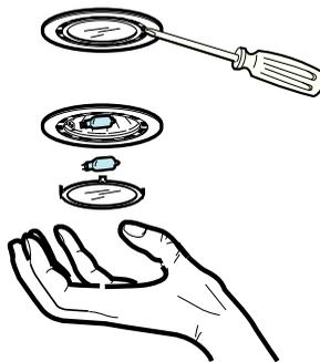
3. Skift ut lyspæren (bruk kun halogene lyspærer maks 20 Watt – type G4 )
