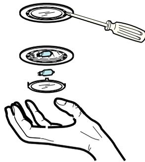
3. Tauschen Sie die Lampe aus (handelsübliche Halogenlampen max. 20 Watt, Sockel G4).
