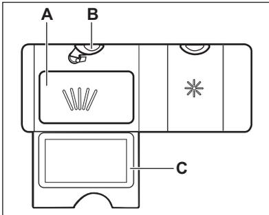
1. Drücken Sie die Entriegelungstaste (B), um den Deckel (C) zu öffnen.
