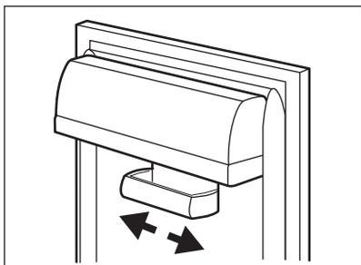
Ce modèle est équipé d'un compartiment de rangement variable qui peut être déplacé latéralement.
