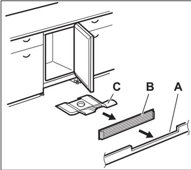
2. Reinigen Sie das Belüftungsgitter.
